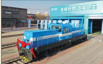
● أول قاطرة كهربائية هجينة تعمل بوقود الهيدروجين تمت عمليات البحث والتطوير الخاصة بها بشكل مستقل في الصين (صورة أرشيفية، شينخوا)
