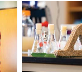
● كتلة على شكل قوس مصنوعة من مواد البناء الحية في مختبر الدكتور سروري.
